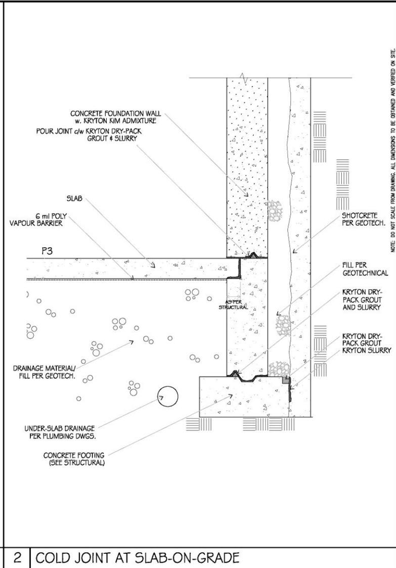
2 COLD JOINT AT SLAB-ON-GRADE
